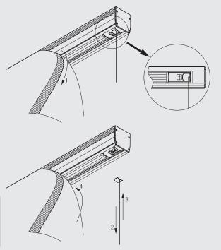
Der neu entwickelte Schnurmechanismus ermöglicht ein einfaches Aufund Abhängen des Behanges.
