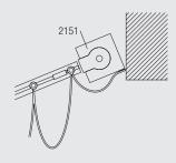
Fixieren des Stoffes direkt an Kopfprofilabdeckung.
