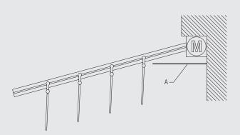
Ein eventueller Lichtspalt auf Motoren- bzw. Paketseite kann optional mit einer Abdeckung (A) reduziert werden.
