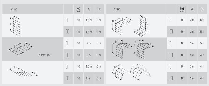
Die maximalen Dimensionen hängen vom Stoffgewicht (inkl. Querstäbe), Anzahl der gekoppelten Anlagen sowie der jeweiligen Anwendung ab. Um den Bedienungskomfort mit Kurbelantrieb zu erhalten beachten Sie die Belastungstabelle.
