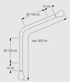
Bitte beachten Sie, den letzten Spanner so nahe wie möglich (max. 10 cm) an der Antriebs-/Umlenkung zu montieren.
