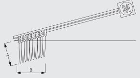
Das Skylight-System kann horizontal oder schräg mit einer Neigung bis zu 30° installiert werden.
