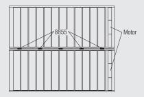
Spezielle Zwischenträger 8855 ermöglichen Seite-an-Seite Montage von mehreren Systemen. Große Glasflächen können somit beschattet werden. Jedes System benötigt einen eigenen Motor.
