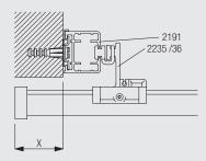
Querträger kann bis maximal 0,80 m (= x) über das Seitenprofil auskragen.
