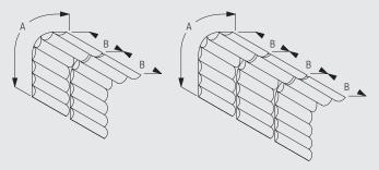
Maximal drei gekoppelte Systeme 2195 können mit nur einem Motor bedient werden. Die maximalen Maße entnehmen Sie bitte der Anordnungstabelle / Belastungstabelle.
