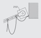
Fixieren des Stoffes direkt an Kopfprofilabdeckung.
