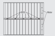
Dazwischenliegende Träger ermöglichen Seite-an-Seite Montage von mehreren Systemen. Riesige Glasflächen können beschattet werden. Jedes System benötigt einen eigenen Motor.
