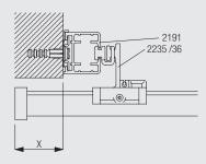
Querträger kann bis maximal 0,80 m über das Seitenprofil (= x) auskragen.
