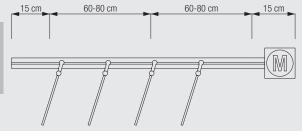
An den abgebildeten Positionen ist die Montage von Trägern erforderlich.
