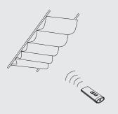
Die Silent Gliss Motoren können mit Funkempfänger ausgestattet werden. In Kombination mit den Silent Gliss Funksteuerungen 9940 bietet dieses System ein maximum an Komfort mit geringem Installationsaufwand. Weitere Informationen finden Sie unter dem Kapitel "Steuerungen".
