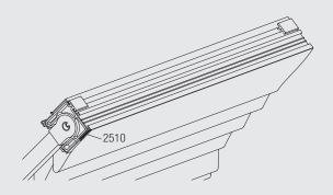
Profil 2151 wird zur Abdeckung der Systemtechnik verwendet. Der Stoff wird mittels Velcro-Klettband am Kopfprofil 2510 befestigt.
